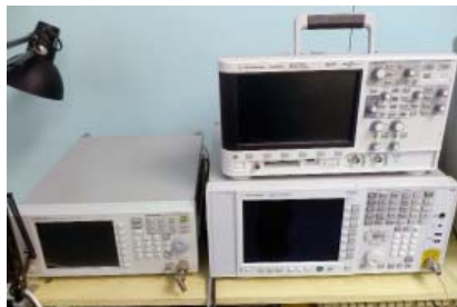
Vlevo VF generátor, nahoře digitální osciloskop, pod ním spektrální analyzátor
