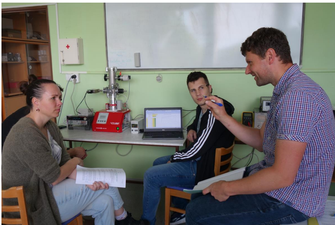
1367 Lektor Martin Zejda diskutuje s účastníky kurzu u úlohy P3: Měření čerpací rychlosti turbomolekulární vývěvy metodou stálého tlaku.
