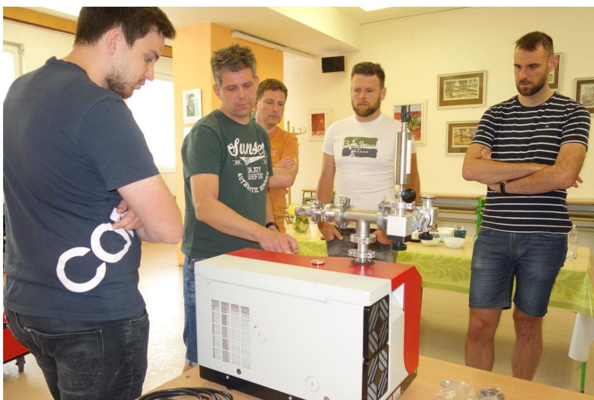
1375 Lektor Jaromír Malík (druhý zleva) zasvěcuje účastníky kurzu do obsluhy heliového hledače netěsností. Vybavení pro měření úlohy P6: Hledání netěsností ve vakuových aparaturách poskytla firma Vakuum servis.
